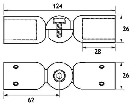
Raccordo angolare regolabile per barre fermavetro a sezione rotonda
